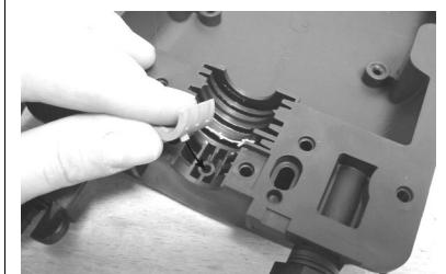
Vue de la boîte avec les ½ bague d'arrimage montées.
